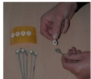
Es ist auch möglich, Elektroden ohne Elektrodenkappe zu kleben. Sie können als flache Elektroden einfach an jeglicher Körperstelle angebracht werden. Wichtig ist aber, dass immer die CMS/DRL-Elektroden mit verwendet werden. Nachdem die Elektroden auf der Kappe angebracht und an den Verstärker gekoppelt sind, sollten die Stränge über den, sich im EEG-Labor befindlichen, Stützarm gelegt werden, um Zug auf die Stränge zu vermeiden und mehr Bequemlichkeit für den Probanden zu ermöglichen.
