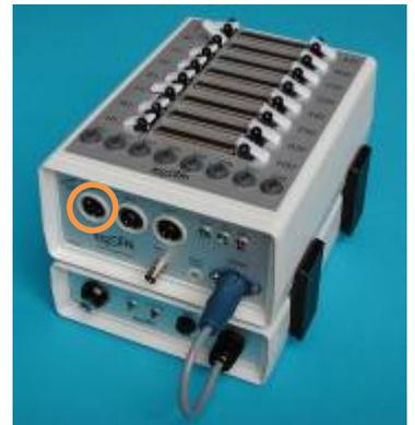
Unter dem Verstärker befindet sich die Batterie an der auch der ON/OFF-Knopf angebracht ist.
