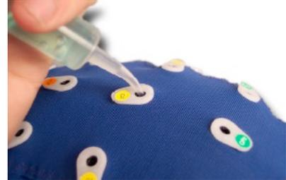
Mit Hilfe der Spritzenspitze sollten die Haare innerhalb der Löcher leicht zur Seite geschoben werden und dann Gel bis etwa zur Öffnung eingefüllt werden. So arbeitet man sich, am besten zu zweit, um den ganzen Kopf herum. Zuletzt sollte noch einmal kontrolliert werden, dass alle Elektrodenhalter mit Gel gefüllt sind.
